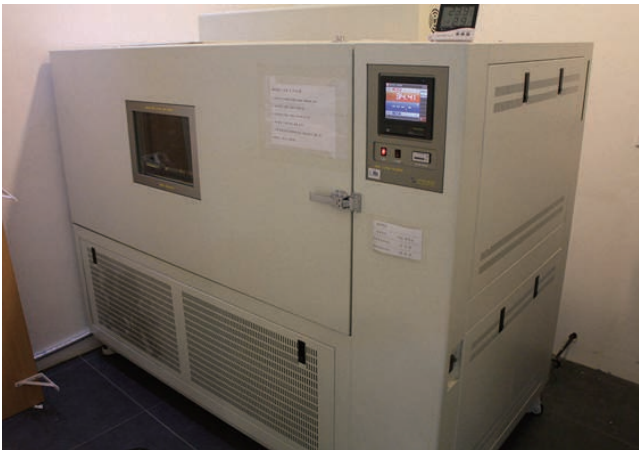
항온항습시험설비 온도(영상,영하), 습도가 조절된 특정한 조건으로 측정하여 수명과 강도를 시험하는 설비
