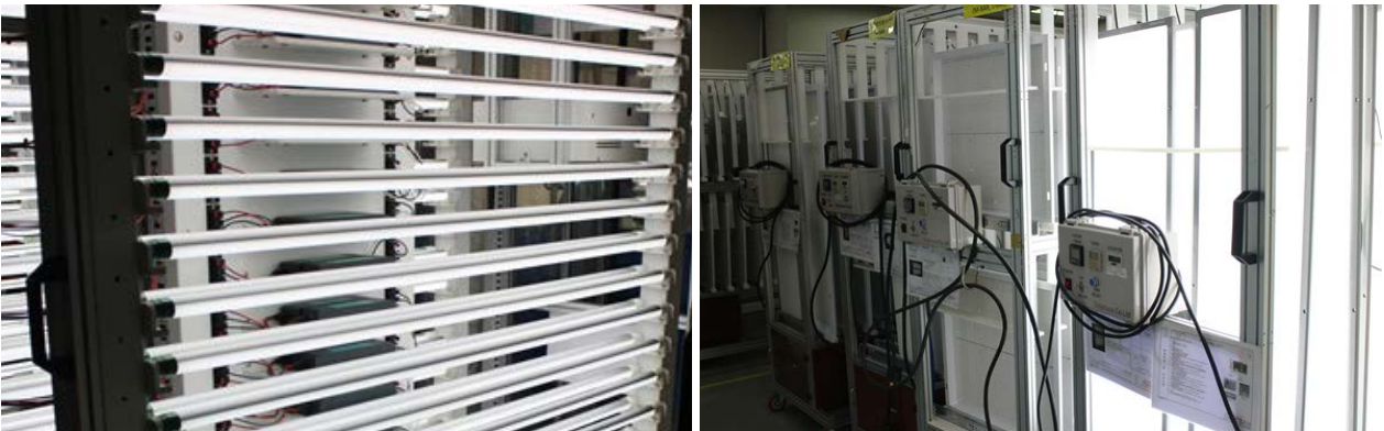
TEST & AGING LINE 공정 별 품질검사 실시 및 제품 완성 후 Aging Test 추가 실시
